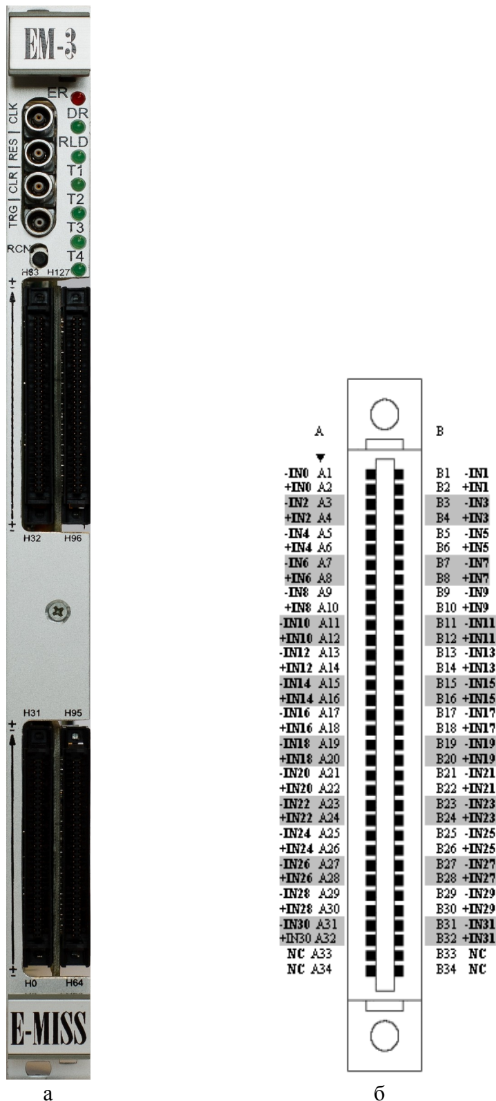
Рис.13. Лицевая панель (а) и входной сигнальный разъём ( б) модуля ЕМ-3.
